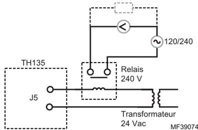
Branchement à une chaudière pour le chauffage à eau chaude, ou à une fournaise pour un système à air chaud.
