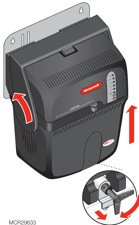
Fig. 3. Re-install tank (Step #15). Réinstallation du réservoir (étape 15). Cómo volver a instalar el tanque (paso n.º 15).
