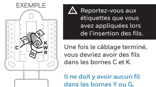
**C** Terminez l'installation de votre nouveau thermostat en le fixant à la plaque murale, en rétablissant le courant et en configurant le thermostat.
