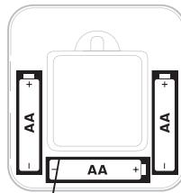
Inserte 3 baterías AA para la alimentación principal o de respaldo. Asegúrese de que la polaridad de las baterías coincida con las marcas +/- en el interior del compartimento de la batería.
