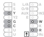
Nota: Es posible que no se utilicen todos los terminales, según el tipo de sistema que se está cableando. Se muestran sombreados los terminales más comúnmente usados.
