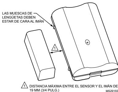
Fig. 9. Distancia máxima entre el sensor de puerta y el imán.
