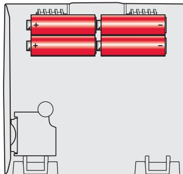
**Fig. 17. Insert AA batteries.**
