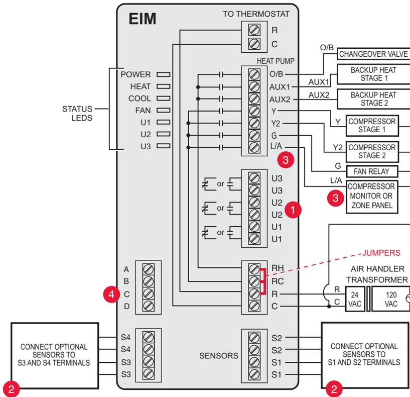
**Fig. 315. EIM wiring guide – heat pump systems.**
