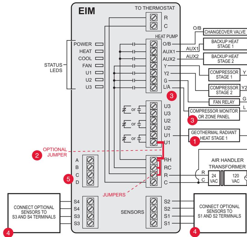
**Fig. 316. EIM wiring guide – geothermal radiant heat.**
