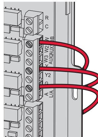
**Fig. 313. Inserting wires in EIM terminal block**
