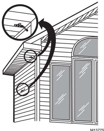
Fig. 7. Installation du capteur de température extérieure.
