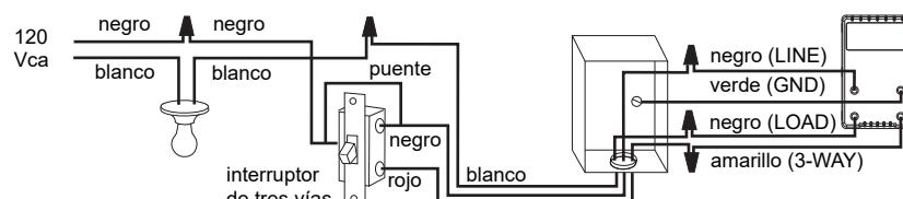
Conectar el cable "LOAD" del PLS550A/PLS551A al cable "común", identificado cuando se retiró el antiguo interruptor. Conectar el cable "GND" al tornillo de puesta a tierra en la caja de electricidad. Conectar los cables "LINE" y "3-WAY" a los dos cables restantes. En el otro interruptor de 3 vías, conectar el cable de puente (provisorio) entre el terminal "común" y el terminal en el que está conectado el cable "LINE" del PLS550A/PLS551A.
