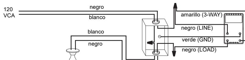
Conectar los cables "LINE" y "3-WAY" a la línea de 120 VCA y el cable "LOAD" a la carga. Conectar el cable "GND" al terminal de puesta a tierra en la caja de electricidad.
