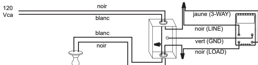
Relier les fils « LINE » et « 3-WAY » à la ligne 120 Vca et le fil « LOAD » à la charge. Relier le fil « GND » à la vis de mise à la terre dans la boîte électrique.
