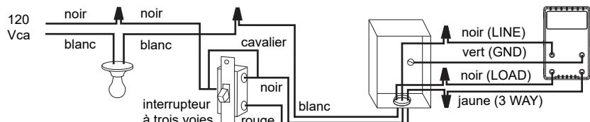
Relier le fil « LOAD » du PLS550A/PLS551A au fil « commun » identifié lorsque vous avez enlevé l'ancien interrupteur. Relier les fils « GND » à la vis de mise à la terre dans la boîte électrique. Relier les fils « LINE » et « 3-WAY » aux deux fils restants. Pour l'autre interrupteur à 3 voies, relier le fil de raccord (fourni) entre la borne « commun » et la borne sur laquelle le fil « LINE » du PLS550A/PLS551A est relié.
