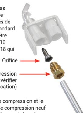
Couper l'ancien raccord de compression et le remplacer par le raccord de compression neuf fourni avec la nouvelle veilleuse. Ne jamais utiliser l'ancien raccord de compression car il pourrait ne pas fournir une étanchéité au gaz adéquate.
