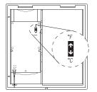
Replacer la partie avant du thermostat sur la base et resserrer la vis d'assemblage au bas de l'appareil.
