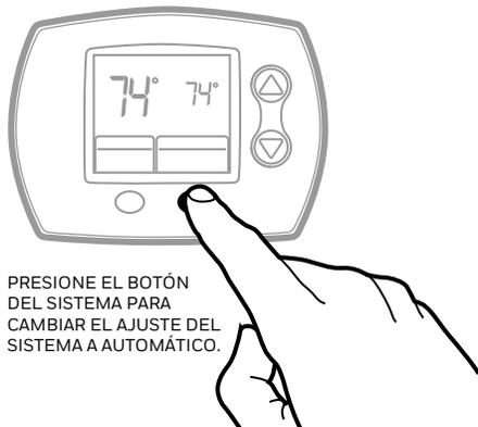
NOTA: El ajuste automático sólo aparece si su distribuidor de calefacción y aire acondicionado configuró el termostato para conmutación automática.
