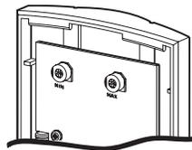
Utiliser un tournevis plat pour ajuster chaque potentiomètre jusqu'à ce que son entaille se pointe vers la limite désirée de la température. Chaque position de potentiomètre correspond à un réglage de température.
