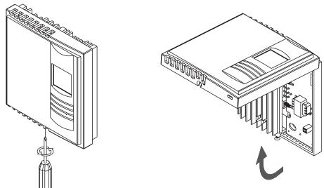
Faire les branchements appropriés. Noter que les fils du thermostat ne sont pas polarisés. Le sens du branchement n'a donc aucune importance.
