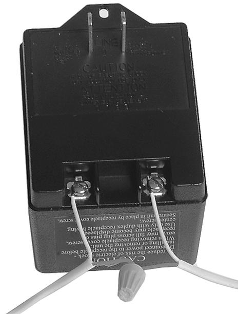
**Fig. 50. Raccordement du transformateur.**
