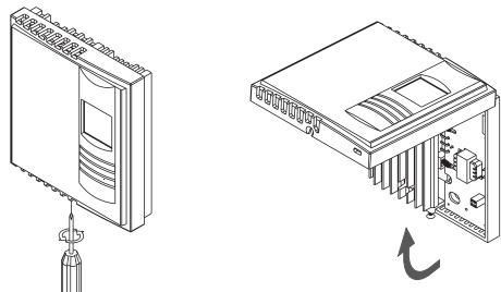
Haga las conexiones necesarias. Tenga en cuenta que los cables del termostato no están polarizados (cualquiera de los cables se puede conectar en cualquiera de las terminales).
