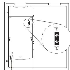
Reemplace la parte frontal del termostato de la base y fíjela en su lugar con el tornillo.
