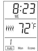
En este modo, el termostato fija automáticamente la temperatura del punto de ajuste según el período del día (despertar, salida para el trabajo, volver a casa y dormir).
