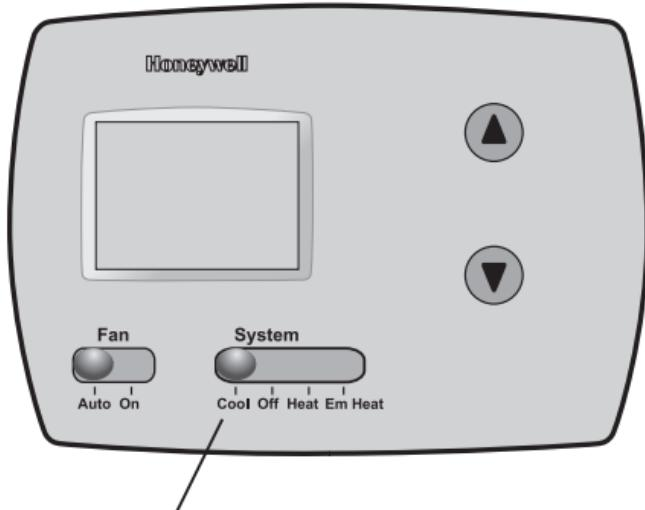
Fije el interruptor del **SYSTEM** (sistema) para controlar el sistema de calefacción y enfriamiento.
