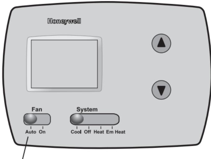
Fije el interruptor del **FAN** (ventilador) para elegir si el ventilador funcionará sin interrupción o sólo cuando sea necesario.
