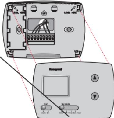
Las baterías son opcionales si su termostato fue conectado para energía CA cuando fue instalado. Instale baterías nuevas de inmediato cuando el aviso **REPLACE BATT** comience a titilar.
