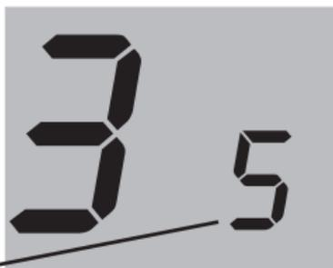
**5** 12 min, chaudière à gaz ou à mazout. Utiliser ce réglage si la chaudière est un modèle à gaz ou à mazout standard et efficace à moins de 90 %.
