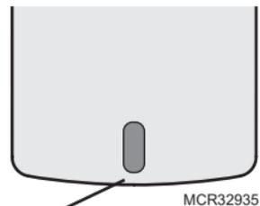
Se a luz de status acender na cor vermelha, o sensor não terá sido conectado ao termostato. Consulte a observação.
